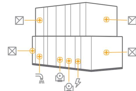
Цифровую модель агрегата для вентиляции и кондиционирования, содержащую параметрические коннекторы:
