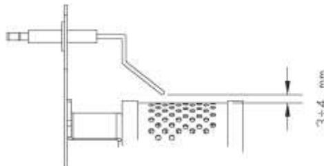
**SCHEMA REGOLAZIONE TERMOCOPPIA - SCHEMA FÜR DIE EINSTELLUNG DES THERMOELEMENTS - SCHEMA DE REGLAGE DU THERMOCOUPLE - THERMOCOUPLE SETTING DIAGRAM - ESQUEMA DE REGULACIÓN DEL TERMOPAR - СХЕМА РЕГУЛИРОВКИ ТЕРМОПАРЫ - AFSTELSCHEMA THERMOKOPPEL - SCHEMAT REGULACJI TERMOPARY**
