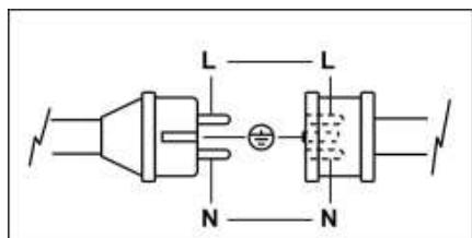
Les modèles A peuvent être raccordés à un thermostat ambiant ou à d'autres accessoires de l'installation (par exemple, l'horloge), en utilisant la prise (10).
